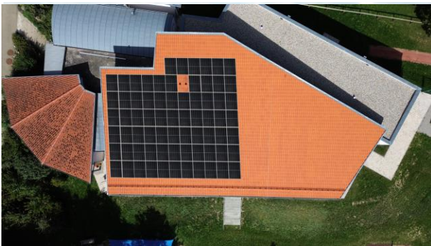
Bsp. Belegung der Dachfläche für 30 kWp
